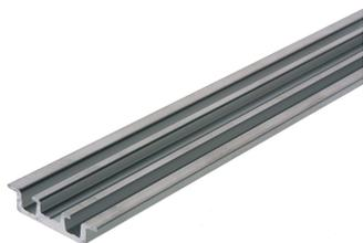
Binario combinato Extrudal-050 DIN35/DIN15, con 35x7,5x3,3 mm, in lega di alluminio, con sezione trasversale in rame da 35 mm<sup>2</sup>, lunghezza 2 m
