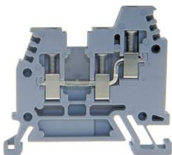
Bloc de jonction en Y DIN35 4mm<sup>2</sup> gris avec 3 raccordements avec vis en acier inoxydable, possibilité de repérage à 3 chiffres des deux côtés, encastré pour les connexions transversales
