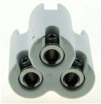
Einspeis-/Verbindungsdose E90, zur Einspeisung (Rundkabel - Flachkabel) oder zur Verbindung (Flachkabel - Flachkabel) für Flachkabel 3G2.5/4 mm<sup>2</sup>. Mit Schrumpfschlauch IP66/68.
