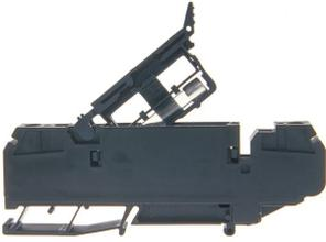
Sicherungsklemme 4mm<sup>2</sup> schwarz für Sicherung 5x20mm für G-Schmelzeinsatz, Isolierkörper Polyamid 6/6 schwarz für Querverbindung versenkt, mit Sicherungshalter
