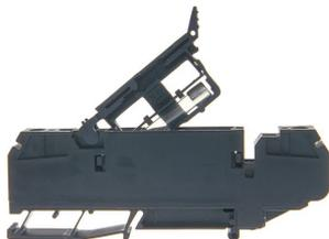
Borne à fusible 4mm<sup>2</sup> noire pour fusible 5x20mm pour cartouche fusible G, corps isolant en polyamide 6/6 noir pour connexion transversale encastrée, avec porte-fusible
