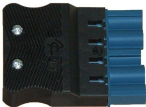
5 poliger Stecker Code 2 mit Schraubanschluss und Zugentlastung zur Selbstkonfektionierung - max. 400V / 16A- blau, halogenfrei. Für Kabel Durchmesser Ø 9.3 - 10.3 mm
