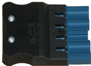
clavija de 5 polos código 2 con conexión de tornillo y alivio de tensión para el autoensamblaje - máx. 400V / 16A- azul, libre de halógenos. Para diámetro de cable Ø 9,3 - 10,3 mm
