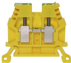
Borne sur rail DIN35 2.5mm<sup>2</sup> 45x5x36mm isolée vert-jaune avec le meilleur contact possible, vis en acier inoxydable, possibilité de repérage à 4 chiffres des deux côtés, encastré pour les connexions transversales
