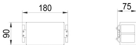
en tôle d'acier galvanisée senzimir 1.5mm
