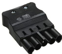
Connecteur à 5 pôles code 1 avec raccordement par vis et décharge de traction, précâblage possible - max. 400V / 16A - noir, sans halogène Pour diamètre de câble Ø 9,3 - 10,3 mm
