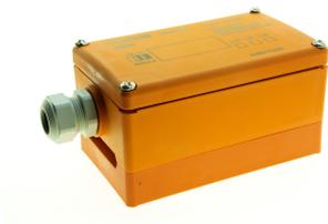
Brandsicherheit Dosen IP66/IP68 für Brandsicherheit-Flachkabel E90 5G16, inkl. Kabelverschraubung, 2-Schrauben-Kontaktierung, zur abisolierfreien Abzweigung, mit Schraubanschluss für Starkstrom 5P 4mm<sup>2</sup> (6mm<sup>2</sup>), längsabgehend, Gewinde M20x1.5.
