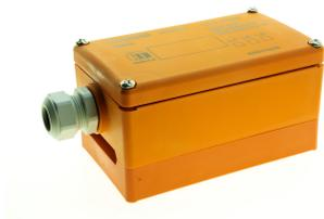
Boîtiers de sécurité incendie IP66/IP68 pour câble plat de sécurité incendie E90 5G16, y compris presse-étoupe, contact à 2 vis, pour la dérivation sans dénudage, avec raccordement à vis pour courant fort 5P 4mm<sup>2</sup> (6mm<sup>2</sup>), longitudinal, filetage M20x1.5.
