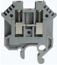
Reihenklemme DIN32 2.5mm<sup>2</sup> 46x6x41mm grau mit bestmöglicher Kontaktierung, Schrauben und Federn aus rostfreiem Stahl, beidseitig 4-stellige Bezeichnungsmöglichkeit, für Querverbindungen versenkt
