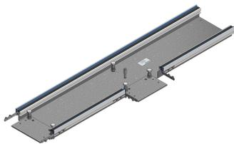
con livellamento integrato In lamiera di acciaio zincata sendzimir 1.5mm con profilo di protezione provvisorio per ampiezza coperchio 300mm inclusi giunti di fissaggio e materiale di connessione
