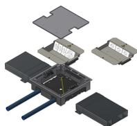
Sistema sottopavimento con plenum quadrato e scatole di giunzione in alluminio, altezza bordo 4 mm per canalina sottopavimento UFK 200x30.
