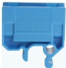
Borne de derivación sin pieza de empuje, tornillos prisioneros con ranura, piezas metálicas de latón niquelado, deslizador antidesplazamiento para conductores pasantes, opción de marcado de 4 dígitos
