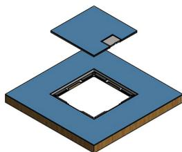
Tôle de suspension pour découpe 255x255mm en acier galvanisé sendzimir 1mm, avec cadre 250x250x12mm en aluminium 2mm, avec caoutchouc d'appui du couvercle 3mm. Couvercle 245x245x4mm en acier zingué sendzimir 4mm, peut être recouvert 3mm, avec sortie de câble en acier chromé.
