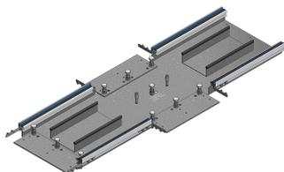
Collegamento trasversale BOK 8880/400x60 con livellamento integrato realizzato in lamiera zincata sendzimir 1,5 mm pressata su entrambi i lati in uno speciale profilo di alluminio Woertz con bordo di protezione temporaneo inserito nella scanalatura e gomma trapezoidale antiurto come supporto del coperchio
