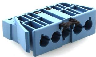
Gerätesteckanschluss zu Woertz-Stecksystem, Stecker, pastellblau, Code 2, 5-polig, verriegelbar. Wandstärke min.: 0,5 mm, Wandstärke max.: 1,2 mm. Geeignet für DALI-Leuchten-Anschlüsse, passend zu Woertz-Flachkabel-Installation.
