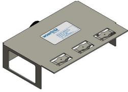
Schwachstrom-Ausführung aus verzinktem Stahlblech 1.5mm mit Zugentlastungsprägungen und Rändelschraube zur seitlichen Befestigung in der Kanalschale. Farbe: RAL 7032 Kieselgrau
