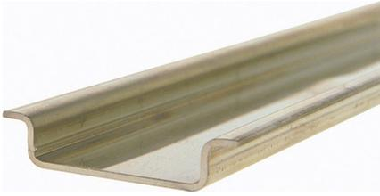
Tragschiene DIN35 mit 35x7.5x1 mm, aus VA4 Stahl, mit einem 16 mm<sup>2</sup> Kupferquerschnitt, 2 m Länge.
