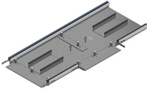
mit integrierter Nivellierung aus sendzimir-verzinktem Stahlblech 1.5mm beidseitig in Spezialaluminiumprofil Woertz eingepresst mit provisorischer Schutzkante in Nut eingelegt und Trittschalltrapezgummi als Deckelauflage Nivelliersechskantschrauben M10x60 Polyamid inklusive Verbindungsmaterial Höhe 60mm / Deckelnennbreite 400mm Länge: 1000mm
