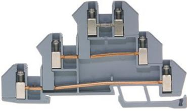
Dreistock Initiatorenklemme DIN35 2.5mm<sup>2</sup> für Einspeisung mit 6 Klemmstellen
