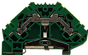
Steckfederklemme teilverschalt mit 4 Anschlussmöglichkeiten und leitender Verbindung zur DIN-Schiene.
