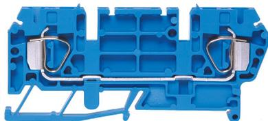
Zugfederklemme DIN35 4mm<sup>2</sup> 88.5x6x35 mm blau mit 2 Anschlüssen für 2 Querverbindungen Bezeichnungsmöglichkeit seitlich und in der Mitte mit Streifen, für Querverbindung versenkt
