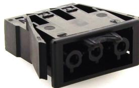
Geräteanschluss für Woertz-Steckdosensystem, Buchse, schwarz, Code 1, 3-polig, abschliessbar. Minimale Wandstärke: 0,5 mm, maximale Wandstärke: 1,2 mm. Geeignet für den Anschluss an das Einphasennetz in Verbindung mit Woertz-Flachkabelinstallation.
