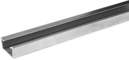
Carril perfilado C30 de 29x15x2 mm de acero galvanizado en caliente, con una longitud de 6 m.
