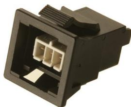
Douille 3 pôles, Code Woertzencoche: 17.8x17.8 mm profondeur de montage: 29 mm épaisseur de tôle compatible: 0.5-2.5 mm
