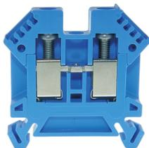
Bloc de jonction DIN35 6mm<sup>2</sup> 49x8x45mm bleu avec le meilleur contact possible, vis en acier inoxydable, possibilité de repérage à 4 chiffres des deux côtés, encastré pour les connexions transversales
