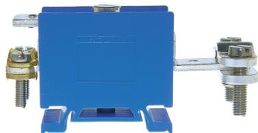
Neutralleitertrenner DIN35 50mm<sup>2</sup> 160A 105x22x46mm Ein- und Ausgang mit Doppelbriden.
