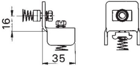
Aus Stahlblech 3 mm, verzinkt, mit Sechskant-Schlitzschrauben aus Stahl verzinkt M6x16, Federringen und Nutensteinen zum Einsetzen in Profilschiene Nr. 4383, Typ C30
