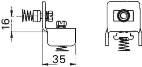
En tôle d'acier 3 mm, galvanisé, avec vis à tête hexagonale fendue en acier galvanisé M6x16, rondelles élastiques et coulisseaux à insérer dans le rail profilé n° 4383, type C30
