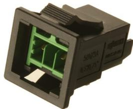
Stecker 2-polig, Code KNX Ausschnitt: 17.8x17.8 mm Einbautiefe: 29 mm geeignete Blechdicke: 0.5-2.5 mm
