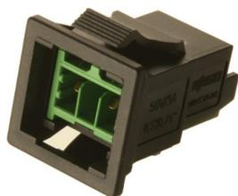
Fiche 2 pôles, Code KNXencoche: 17.8x17.8 mm profondeur de montage: 29 mm épaisseur de tôle compatible: 0.5-2.5 mm
