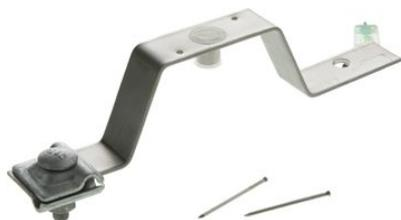
Pourvu d'un écrou à sertir M10 et d'une plaque de serrage à l'extrémité inférieure. La languette de dérivation permet d'effectuer des dérivations sur le conducteur isolé du kit de raccordement à l'intérieur du coffrage ou d'installer des points de raccordement pour la protection contre la foudre, l'équipotentialité, etc. à partir d'armatures verticales reliées par conduction. Points de raccordement sur les surfaces murales, à l'intérieur ou à l'extérieur du bâtiment.
