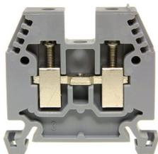
Bloque de terminales DIN35 6mm<sup>2</sup> 45x7x42mm gris con el mejor contacto posible, tornillos de acero inoxidable, opción de marcado de 4 dígitos en ambos lados, empotrado para conexiones cruzadas
