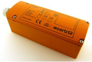
Brandsicherheitsdose IP66/IP68, 2-Schrauben-Kontaktierung zur abisolierfreien Einspeisung und Abzweigung, mit Schraubanschluss für Starkstrom 5G2.5 mm<sup>2</sup>, längs abgehend, inkl. 2 x Kabelverschraubungen M25x1.5, mit einem Klemmbereich von jeweils Ø 12.5-16 mm, und Ø 16-20.5.
