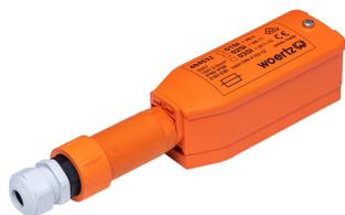
Brandsicherheitsdose mit Sicherungsadapter IP66/68 für Flachkabel FE180 E90 3G4mm<sup>2</sup>inkl. 3 x Kabelverschraubung M20x1.5, mit einem Klemmbereich von jeweils Ø 6-8 mm, Ø 8-11 mm und Ø 11-15 mm Projektspezifische Ausführung auf Anfrage siehe Dokument/G00'299
